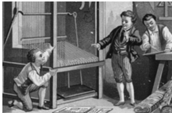
Avec son métier à tisser piloté par cartes perforées, Jacquard crée la première machine à programme externe (ou logiciel). Cf. Le Monde numérique , 2002, Larousse/VUEF
